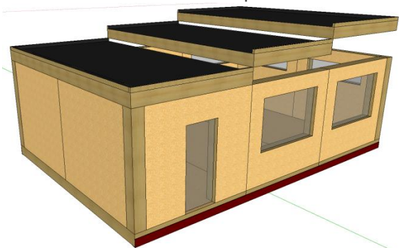
4/ Pose du mur suivant et du premier mur en coin
